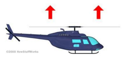
O comando coletivo muda o ângulo de ataque nas duas pás simultaneamente.
