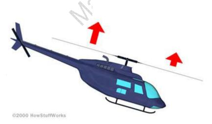
O coletivo permite que você mude o ângulo de ataque do rotor principal nas duas pás simultaneamente
