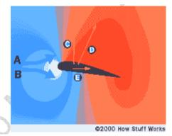
A. o ar aproximando-se da parte superior da asa é comprimido no ar acima dele, conforme se desloca para cima. Assim, visto que a parte superior se curva para baixo e para longe do fluxo de ar, uma área de baixa pressão é desenvolvida - e o ar acima é empurrado para baixo, em direção à traseira da asa;
