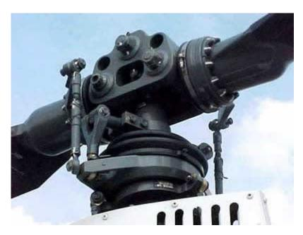
O cubo da hélice do rotor principal, onde as pás e o prato oscilante se conectam, tem que ser muito forte e ajustável. O conjunto do prato oscilante é o componente que fornece ajustabilidade.
