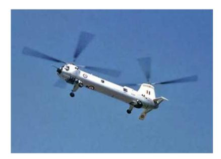
Helicóptero do tipo rotor gêmeo com uma porta de carga grande e de levantamento externo, e é usado para transportar pára-quedistas, evacuação de vítima, e para erguer cargas grandes.
