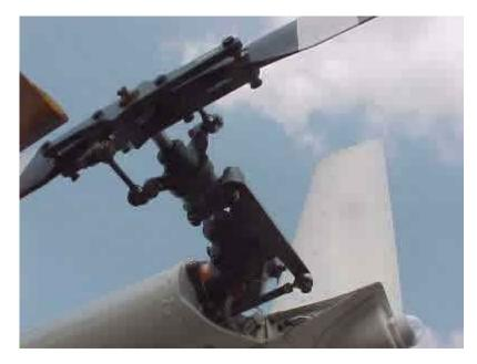
O cubo da hélice do rotor de cauda permite ao piloto mudar o ângulo de ataque das pás do rotor
