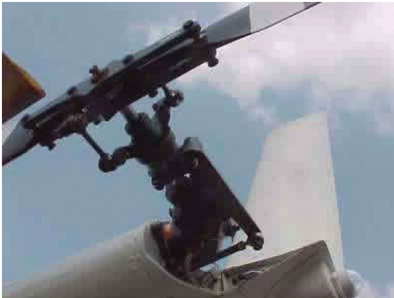
O cubo da hélice do rotor de cauda permite ao piloto mudar o ângulo de ataque das pás do rotor
