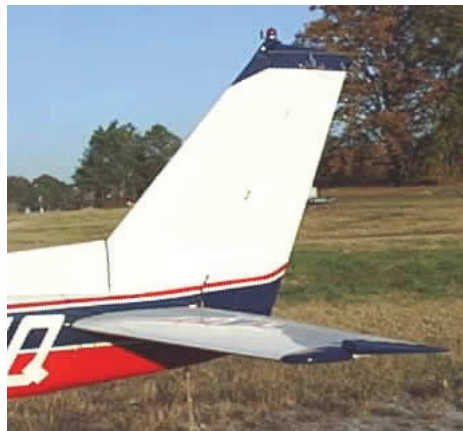
Asa horizontal (estabilizador e profundor) na cauda
