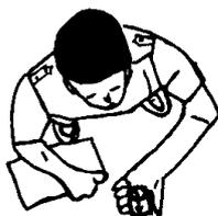
Segure a bússola firmemente com a flecha de direção apontando diretamente para o ponto de referência. Gire a caixa até a flecha impressa no fundo coincida com a agulha magnética. Leia o número que coincide com a flecha de direção. Esse número encontrado é o rumo, em graus.
