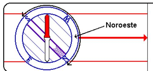
Segure a bússola na sua mão. Você deverá segurá-la bem horizontal, de modo que a agulha possa girar livremente. Quando ela parar totalmente, gire a bússola lentamente, tendo cuidado para que o anel da agulha não gire, até que a agulha magnética da bússola coincida com o norte desenhado no alojamento, em outras palavras "zere" a bússola. A linha de direção estará então, apontando para a direção desejada.
