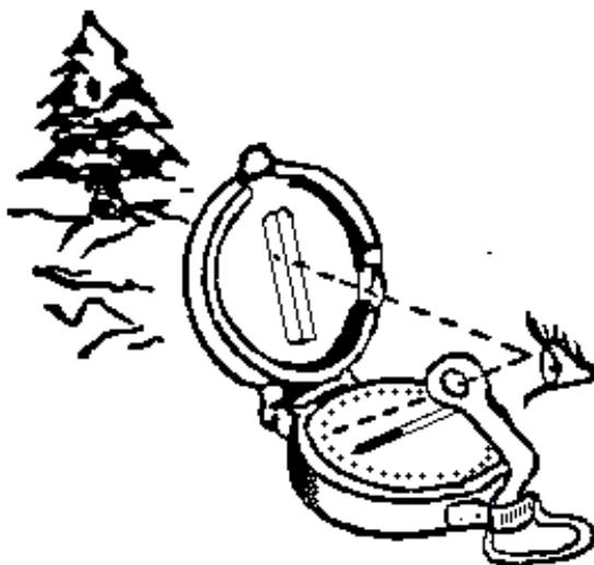
azimute magnético com bússola prismática
