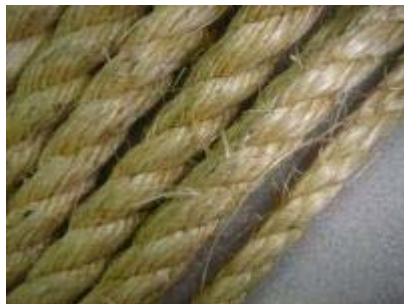
Ilustração 3 - Cordas de sisal de vários diâmetros
