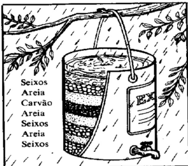
Ilustração 13 – Filtro de campo para limpeza de água.
