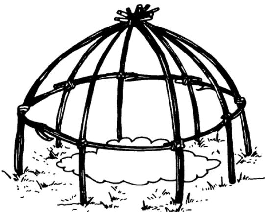
Ilustração 8 - Construção de armação de varas para cobertura com palha
