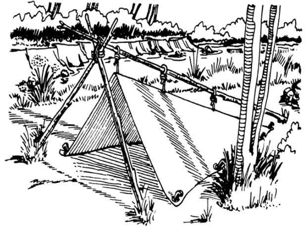
Ilustração 2 - Construção de abrigo simples com lona e que recebe o nome de "ratoeira"
