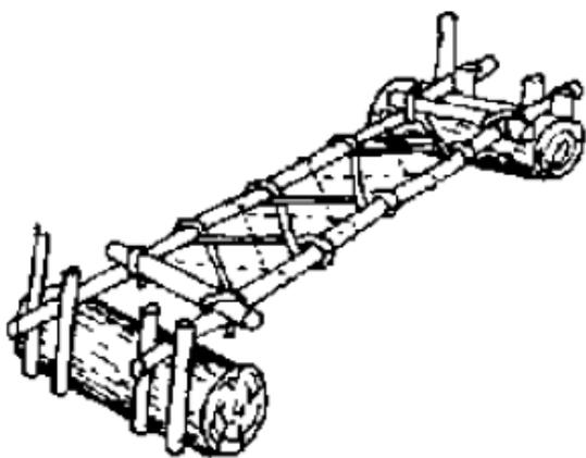
Ilustração 11 - Cama Construída com recursos de campo
