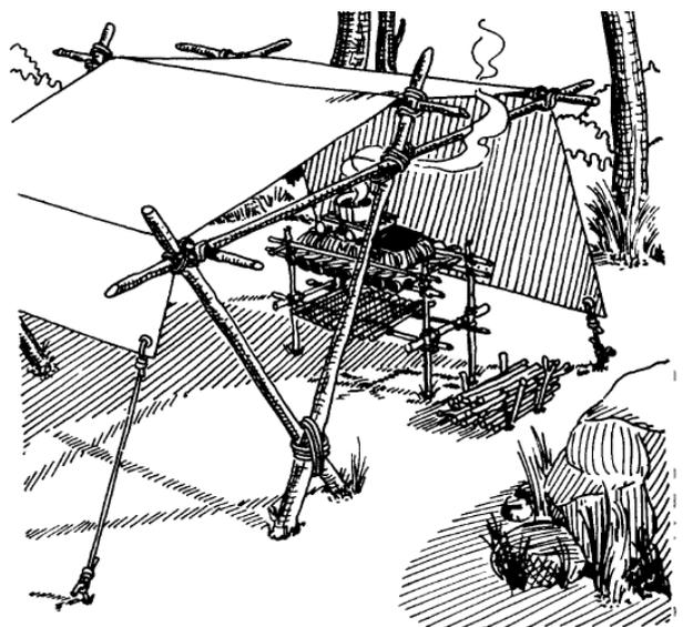
Ilustração 3 - Cozinha que maximiza o espaço com a baixa inclinação do toldo de cobertura
